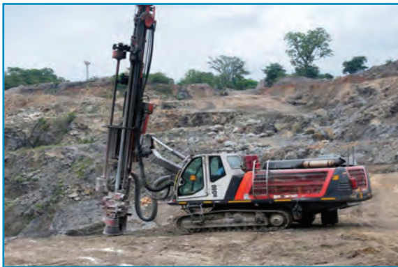
आधुनिक पर्यावरण के अनुकूल हाइड्रो स्टेटिक ड्रिल मशीन
